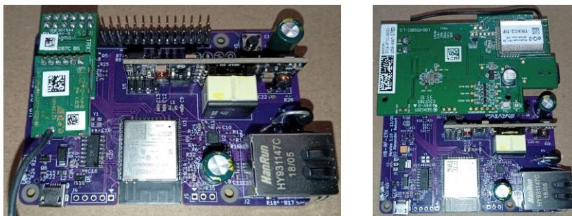
**Es darf niemals gleichzeitig eine Spannungsversorgung per USB (Netzteil oder Anschluss an PC) und über ein Netzteil am RPI-RF-MOD erfolgen, da es sonst zu Beschädigungen der Platine, oder der angeschlossenen Geräte kommen kann.**
