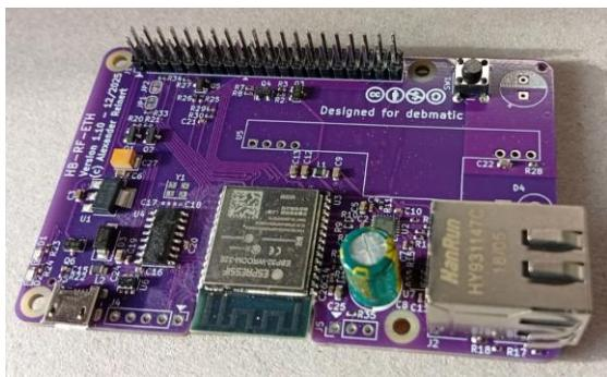
Optional bei PoE Erweiterung: Im Anschluss an den Zusammenbau des Basismoduls wird Kondensator C1 eingelötet. Auch hier ist auf die Richtung Polung zu achten. Es folgt die Diode D4. Diese muss vor dem Einlöten mit einer Spitzzange zuerst zurechtgebogen werden, auf die Polung muss dabei nicht geachtet werden, da es sich um eine bidirektionale Diode handelt:
