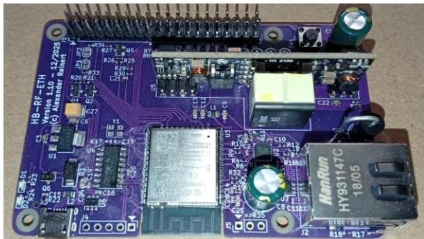
Zum Abschluss erfolgt eine Prüfung der Lötstellen, hier ist insb. auf kalte Lötstellen und Lötbrücken zu achten.
