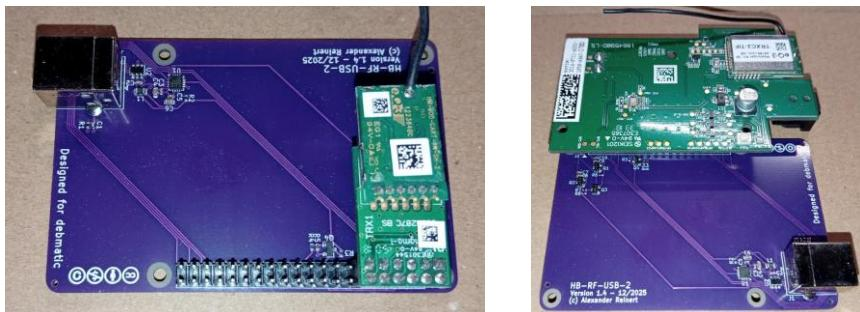
**Die Stromversorgung erfolgt per USB. Bei Verwendung des RPI-RF-MOD darf kein Netzteil an das Funkmodul angeschlossen werden, da es sonst zu Beschädigungen der Platine, oder der angeschlossenen Geräte kommen kann.**
